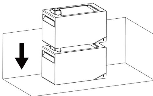
Schritt 6: Drehen Sie das feste Gelenk an das entsprechende Loch der oberen Batterie und ziehen Sie die Schraube fest, um es zu fixieren.
