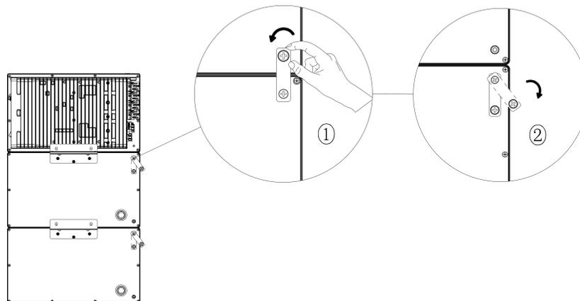
5. Gegebenenfalls entfernen Sie die Haltehalterung von der hinteren Abdeckung der verlängerten Batterie.
