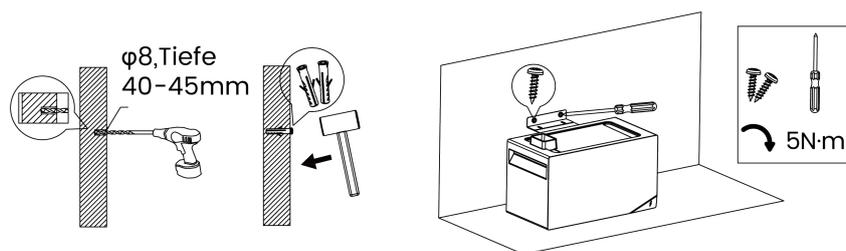
Schritt 5: Installieren Sie die erforderlichen gestapelten Batterien gemäß der in der Abbildung gezeigten Ausrichtung.
